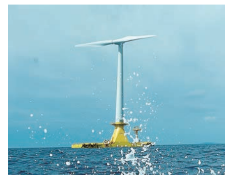
NEDO 次世代浮体式洋上風力発電システム「ひびき」(北九州市様ご提供)
