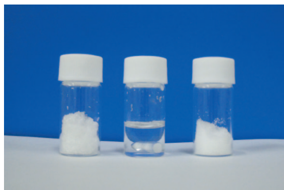
図 左右のサンプルは固体の塩化コリンと尿素。中央のサンプルは1:2のモル比で混合した液体状態の深共晶溶媒。
