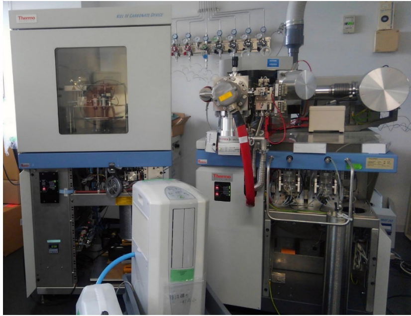
図 8: 国立科学博物館の安定同位体比質量分析計 (MAT253, Kiel Device IV)。この機械を用いて、有孔虫化石の酸素同位体比を測定し、その結果を世界的な酸素同位体比の標準的な曲線と比較することで地層の詳しい年代を明らかにするとともに、当時の海水の水温などの推定を行った。
